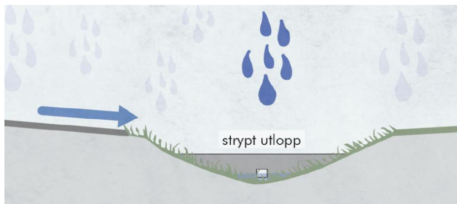
Figur 23. Principskiss för svackdike med strypt utlopp. Illustration: Sweco.
