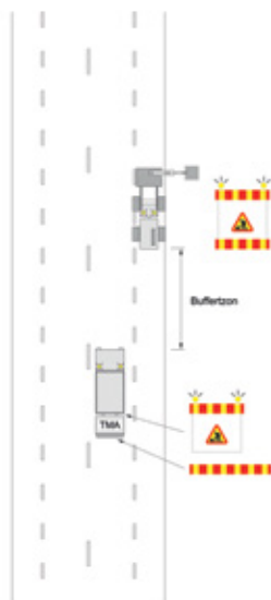
13. Arbete i vägrenen – trafikintensiv gata
