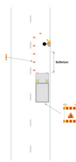
6. Arbete på gatans ena sida
