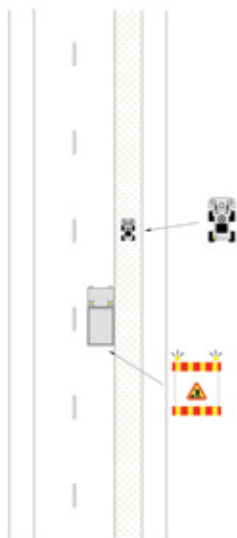
10. Arbete intilliggande gata - i skiljeremsa
