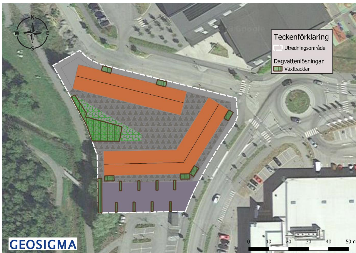
Figur 6-6. Förslag till placering och ungefärlig dimensionering av dagvattenlösningar i form av växtbäddar som föreslås inom utredningsområdet.
