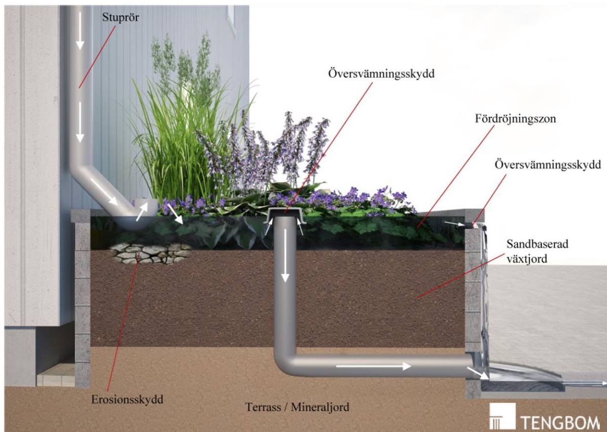
Figur 6-4. Växtbädd/regnbädd i en stenkista placerad intill byggnad vid utkastare från stuprör. Illustration av Kent Fridell 2014.
